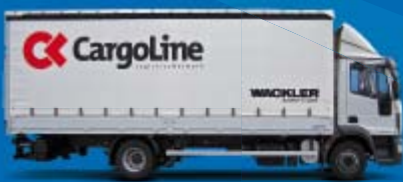
» Schiebeplanen-Aufbau leichte Baureihe mit Ladebordwand und Planenbeschriftung
