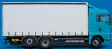
» Curtainsider-Aufbau der schweren Baureihe mit Portaltüren am Heck
