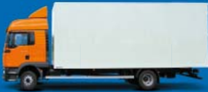
» Aluminium-Möbelkoffer mit Portaltüren, Stäbchenzurrleisten, Innenverkleidung
