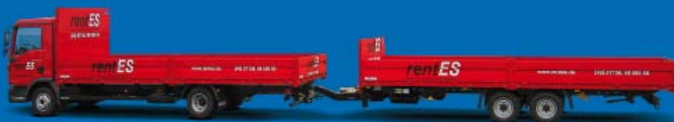
» Anhängerzug mit offenen Pritschenaufbauten, unterschiedlich hohe Stirnwände
