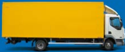
» Backwarenkoffer mit Kiemenlüftung, Ladebordwand, lebensmittelechter Auskleidung
